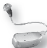
Achter het oor, luidspreker in gehoorgang Voor de kleinste typen hoortoestellen.
